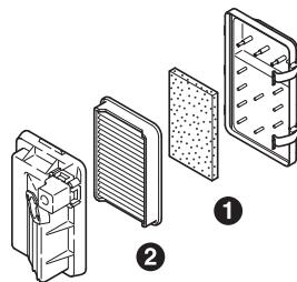
Nettoyer et changer plus souvent les éléments du filtre à air si le moteur est utilisé en environnement poussiéreux.
